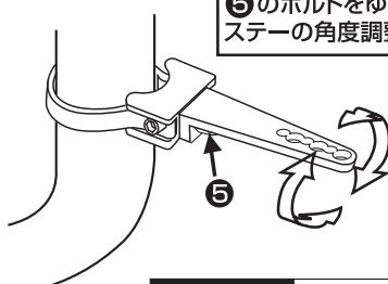
**⑤** のボルトをゆるめてステーの角度調整します。
